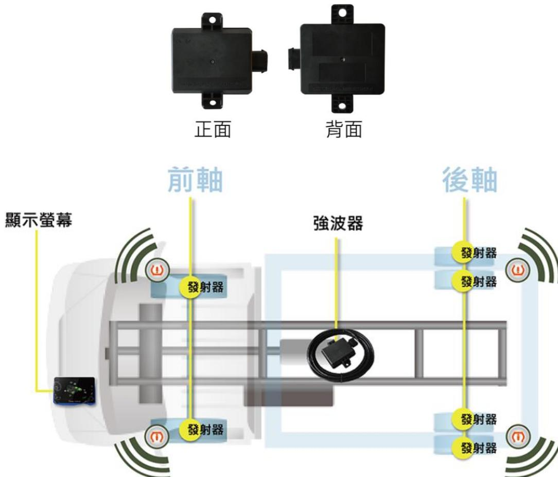
無線胎壓感測發射器安裝
