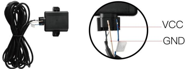
3. 請將接收器的背面朝著底盤面使用束線帶固定 , 請務必保持正面與側面無遮蔽物 , 以免產生訊號遮蔽。
